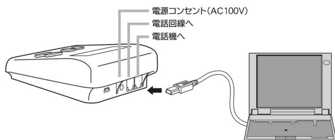
本製品とUSBケーブルを接続し、パソコンのUSBポートに接続してください。
