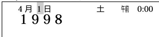
機能キー押下により、日が確定され時の設定に移り、時のセグメントが点滅する。曜日は自動設定する。メモリキー(  または  )で時を設定する。
