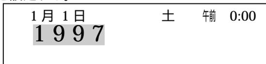
機能キー押下により、年が確定され月の設定に移り、月のセグメントが点滅する。メモリキー(  または  )で月を設定する。
