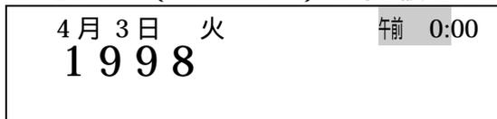
機能キー押下により、時が確定され分の設定に移り、分のセグメントが点滅する。メモリキー(  または  )で分を設定する。
