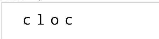
機能キー押下により時刻設定モードに入ると、西暦年が点滅するので、メモリキー(  または  )で年を設定する。
